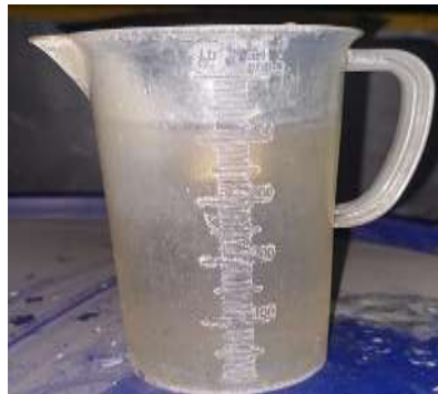
Gambar 6. Gelas Ukur Sebagai Alat Uji Proses Verifikasi Flowmeter
