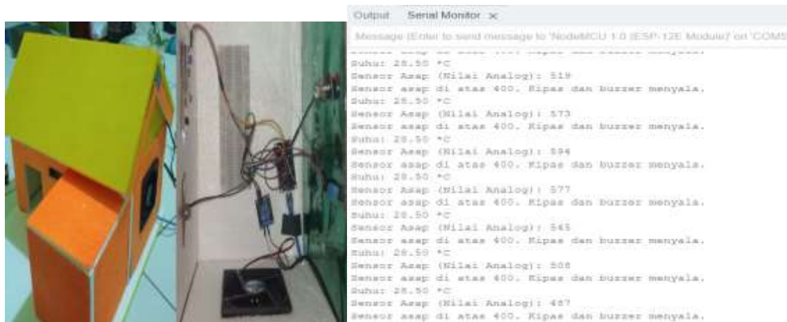
Gambar 2. Hasil Pengujian Perangkat Lunak Pada Serial Monitor
