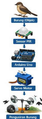
Gambar 1. Diagram Arsitektur Sistem Pengusiran Burung.
