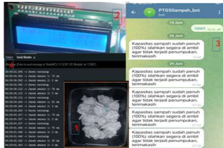
Gambar 11. Hasil Uji Sensor Ultrasonik 2 (sensor kapasitas)
