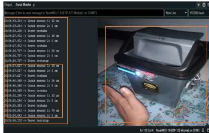
Gambar 10, Hasil uji sensor ultrasonik 1(sensor Jarak)
