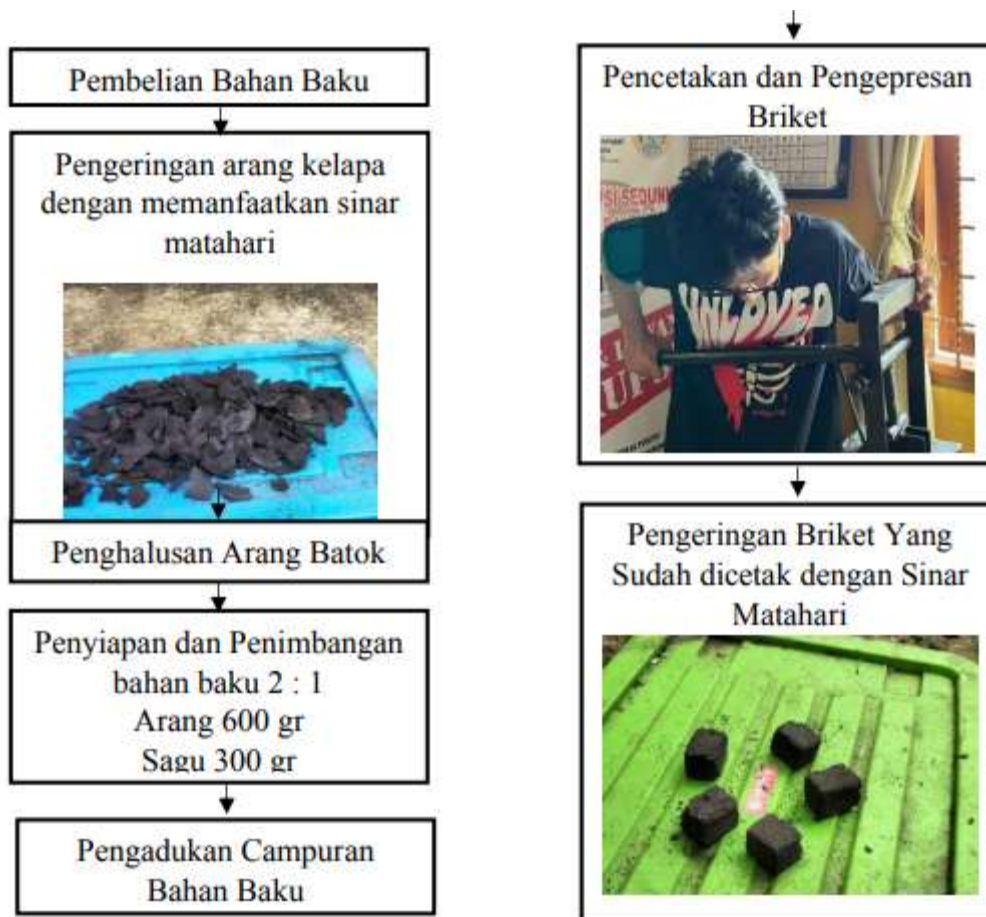
Gambar 7. Diagram pembuatan Biobriket
