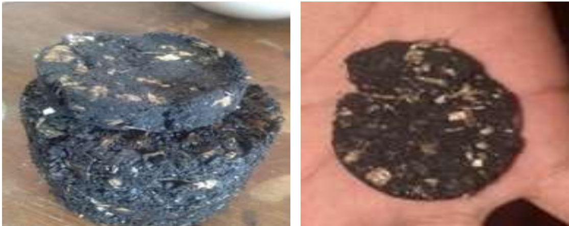
Gambar 3. Briket dari limbah baglog jamur tiram
